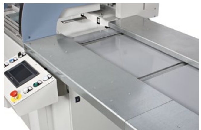
Piano di lavoro con doppia stazione di carico Working table with double marking station Plan de travail avec double station de chargement Mesa de trabajo con doble estación de carga Рабочий стол с двойной станцией для маркировки Arbeitsfläche mit doppelter Ladestation
