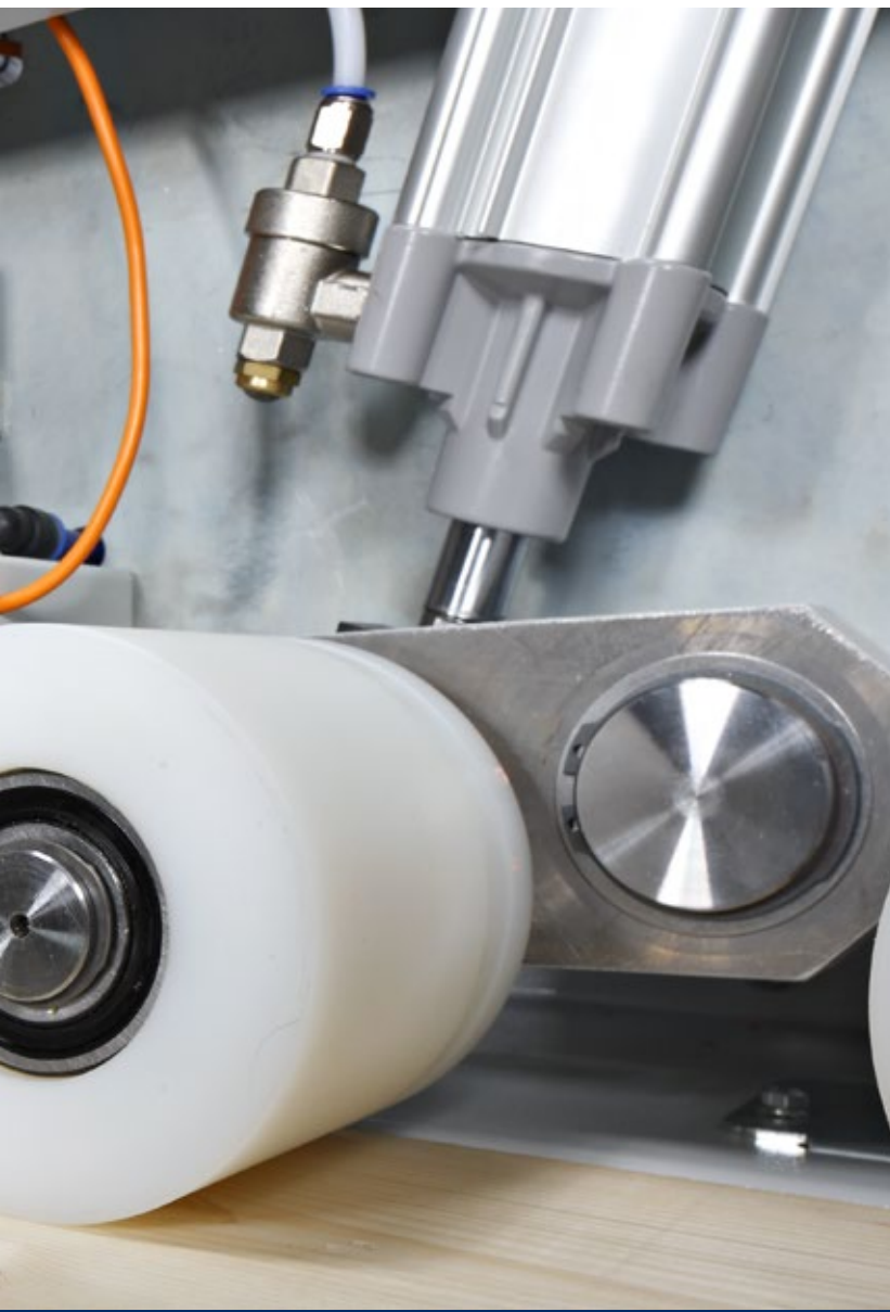
Gruppo di taglio e trascinamento Feed and cutting unit Group de coupe et de d'entraînement Grupo de corte y arrastre Торцовочный узел и подача Schneide- und Vorschubeinheit
